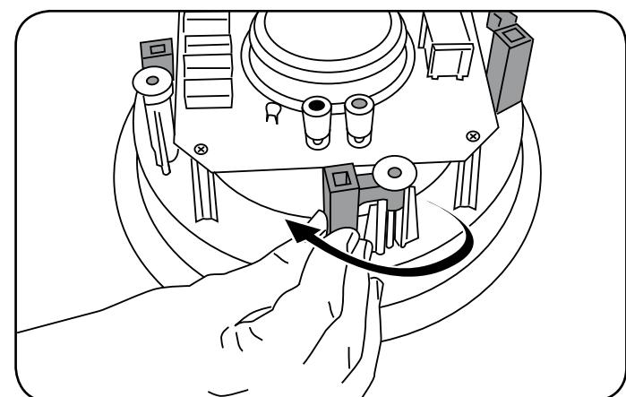
Stecken Sie nun das Lautsprechersystem in die Einbauöffnung und ziehen Sie die Schrauben an. Dadurch bewegen sich die Befestigungslaschen in eine senkrechte Position. Ziehen Sie die Laschen nun mit der Schraube so an, dass der Lautsprecher stabil in der Einbauöffnung fixiert wird. Wichtig: Die Schrauben nicht zu fest andrehen, damit die Befestigungslasche nicht beschädigt wird.
