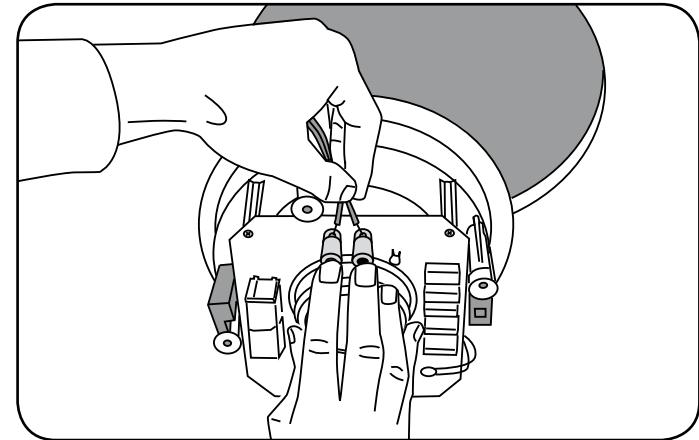
Stehen die roten Befestigungslaschen waagerecht und sind die Schrauben leicht eingedreht, sind sie bereit für den Einbau.
